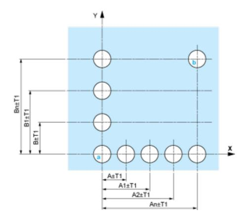
**A:** 30 mm min. / 1.18 in. min. **B:** 40 mm min. / 1.57 in. min.
